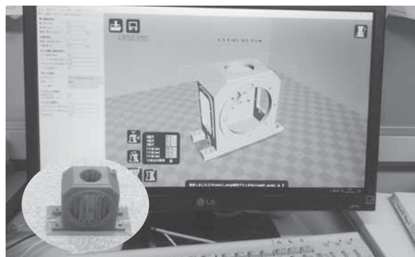
3DCADモデリングから3Dプリンタによる試作
